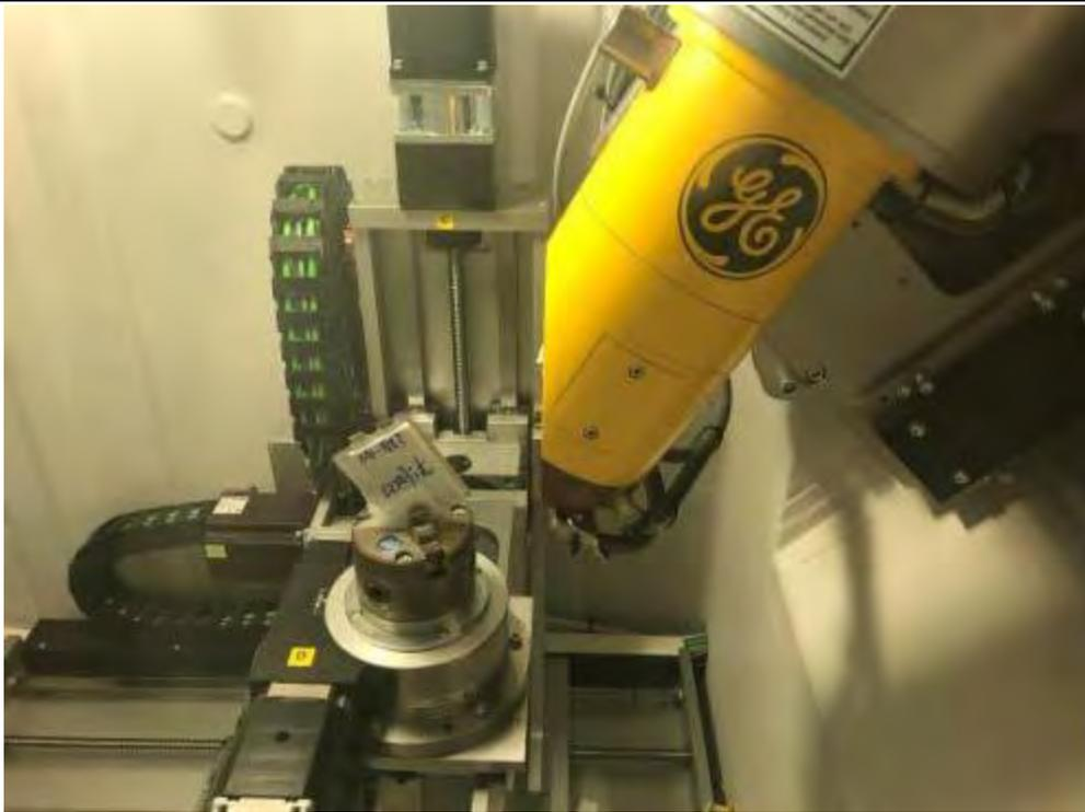
图 9-5 本项目 2 台工业 CT 装置的内部构造示意图
