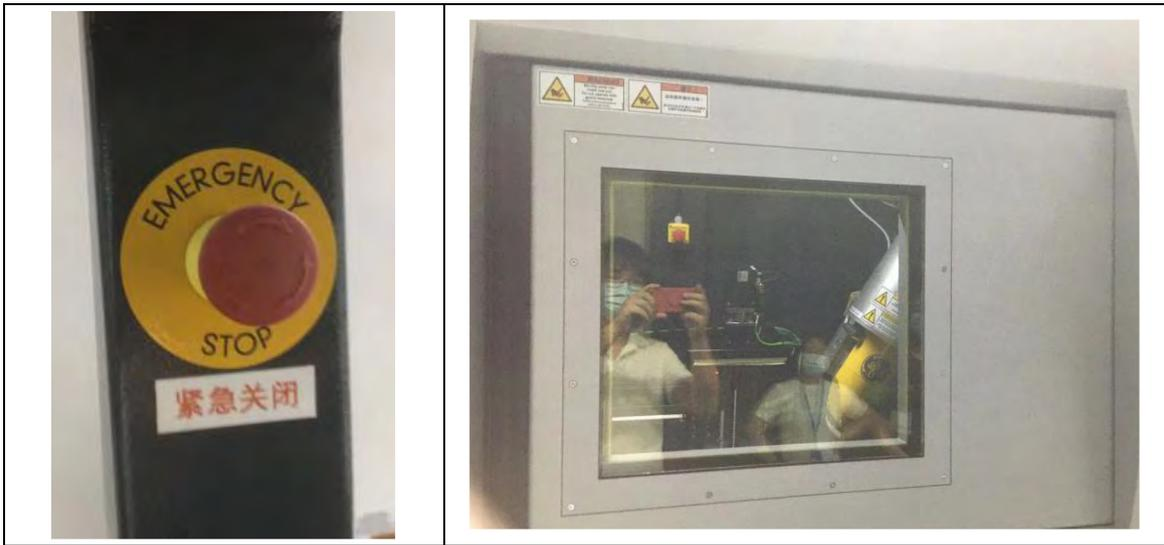
图 10-9 设备内外急停按钮（同款设备示意）
