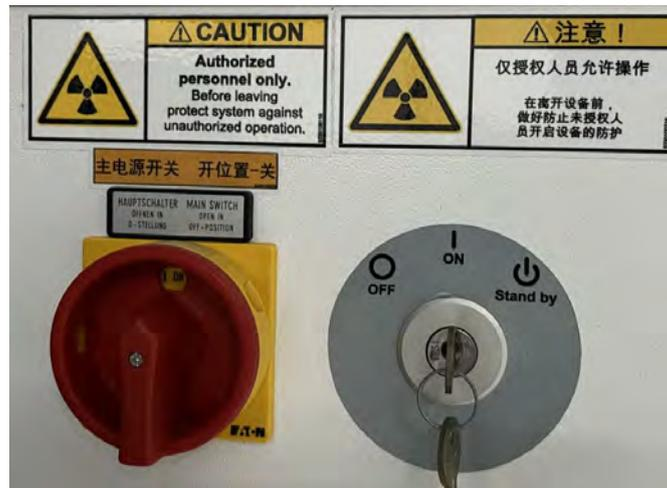
图 10-8 设备总开关、钥匙开关示意图(同款设备示意)
